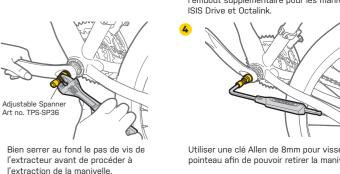
Utiliser une clé Allen de 8mm pour visser la vis pointeau afin de pouvoir retirer la manivelle.
